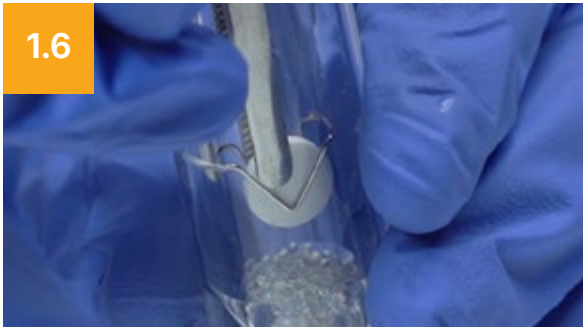
固定样品于药支架 放入药支架，测试样品固定于支架上。
