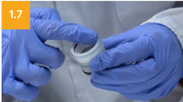
涂抹水进行润滑2 每个密封圈的位置都需涂抹水后装配，以便安装到位减少渗漏。
