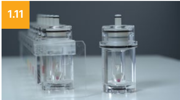
固定于流通池支架上 流通池的金属支柱背靠流通池支架，固定于流通池支架上。
