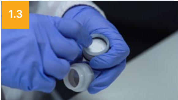
涂抹水进行润滑1 盖子边沿密封圈位置涂抹水进行润滑，以便安装到位减少渗漏。
