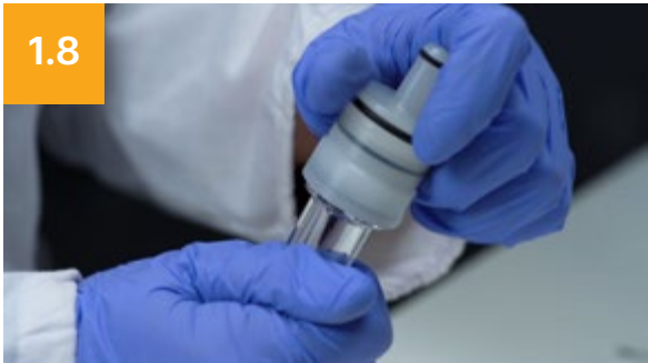
封盖 合上内层流通池的密封盖。
