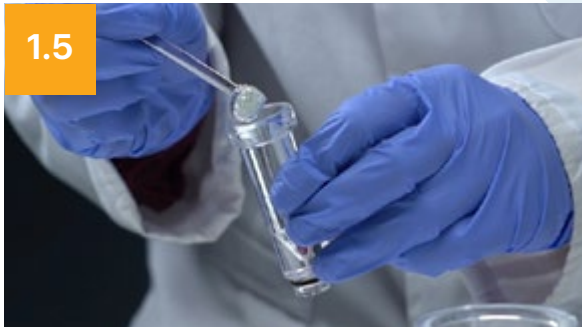
导入玻璃珠 用勺子将适量的玻璃珠导入池内，减少湍流。
