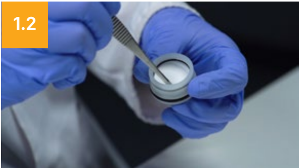
放入滤膜 根据实验要求放入不同孔径的滤膜，可以单层或多层。
