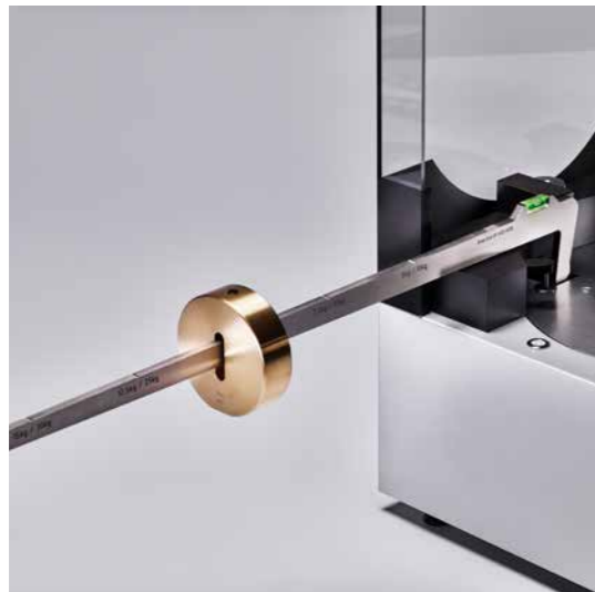
通过一个独立的 SmartCal™ 参考砝码在多个位置上进行静态验证
